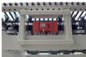
Direkterregung des Siebdecks
