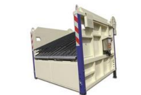
Vorderwand mit Hardox verstärkt
