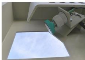
Sensor versetzt die Siebmaschine in Arbeit
