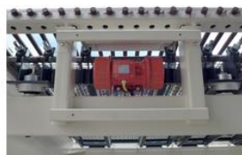
Direkterregung des Siebdecks
