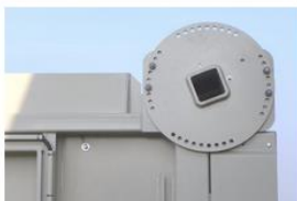
Neigungsverstellung des Stangensizers
