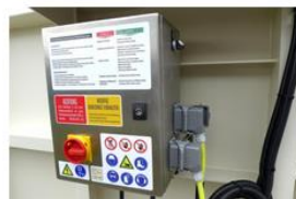
Schaltschrank mit Kurzanzleitung
