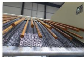
Stangensizer - gespreizter Verlauf
